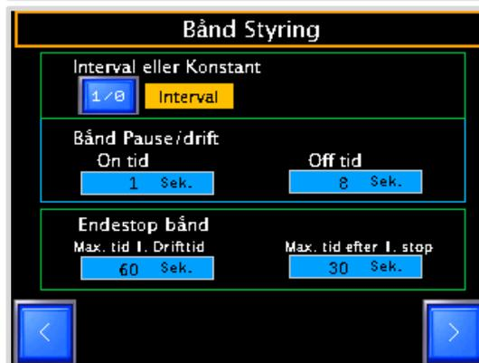
Вышеописанные установки не могут применяться в случае использования чистящей ленты, оборудованной самостоятельной системой управления. В этом случае система управления барабаном не будет получать сигналы с датчиков.
