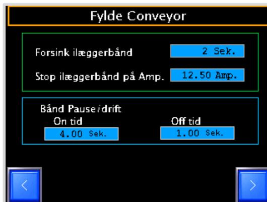
**Остановить загружающую ленту при определённом количестве ампер:** при помощи этой функции можно установить ленту таким образом, чтобы она прерывала наполнение барабана в то момент, когда на него будет подана нагрузка в виде определённого количества ампер.
