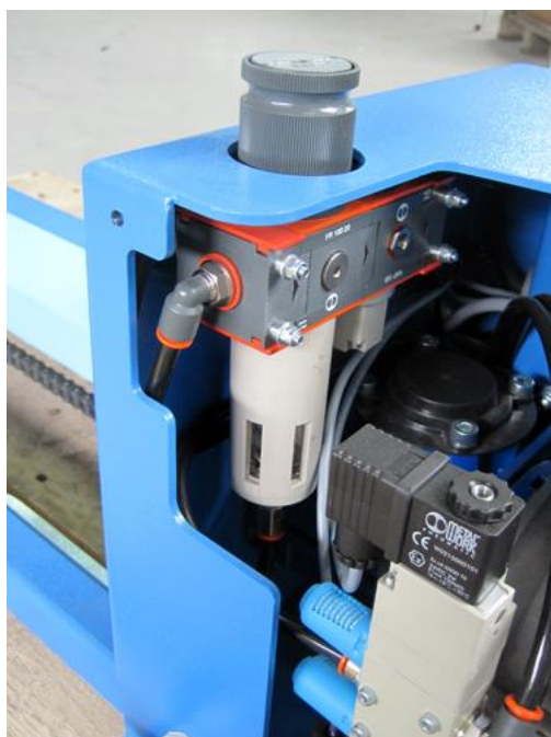
Zdj. 2 Separatory wody
