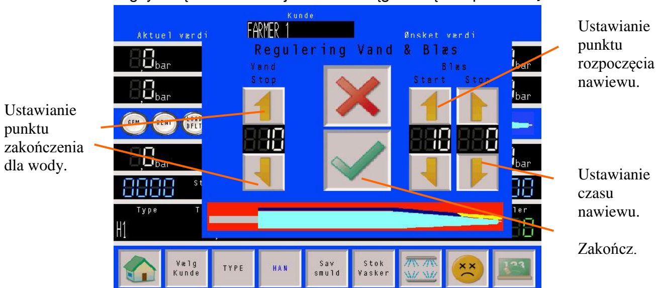
17 Regulacja wody i nawiewu
