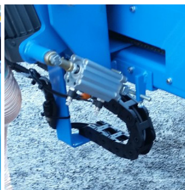
Justering af skrabcylinderens hastighed foregår via trølleventil
