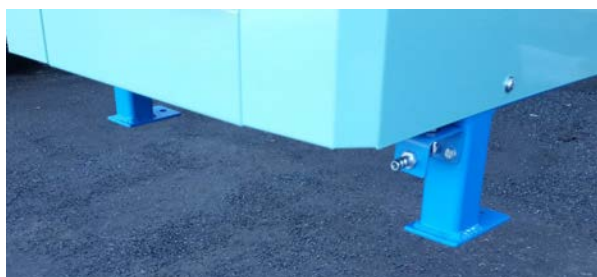
Maskinen fastgøres til gulvet med 3 skruer M10x100mm.
