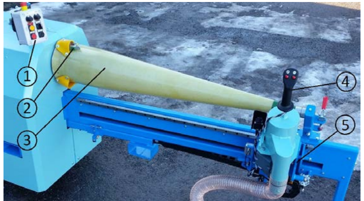
Billedet viser: operatorpanel (1), klemmen (2), stift (3), joystick (4), vognen i hvilepositionen (5).
