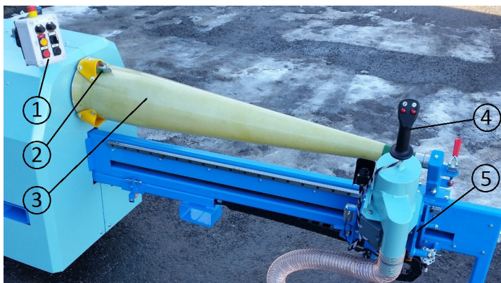
Na zdjęciu widać: panel operatora (1), zacisk (2), trzpień (3), joystick (4), wózek w położeniu spoczynkowym (5).
