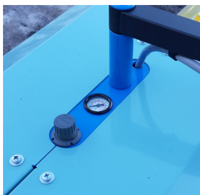
Regulator ciśnienia i manometr do ustawiania nacisku mizdrowania
