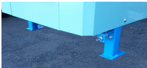
Машина крепится к полу с помощью 3 анкерных болтов M10x100мм.
