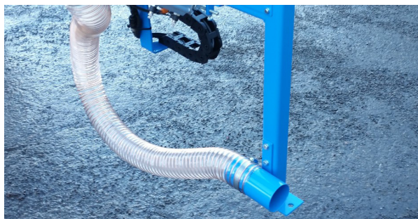
Подключите шланги для откачивания жира.
