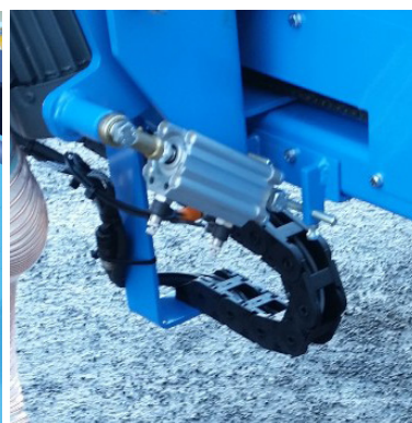
Регулировка скорости цилиндра на одноходовом клапане
