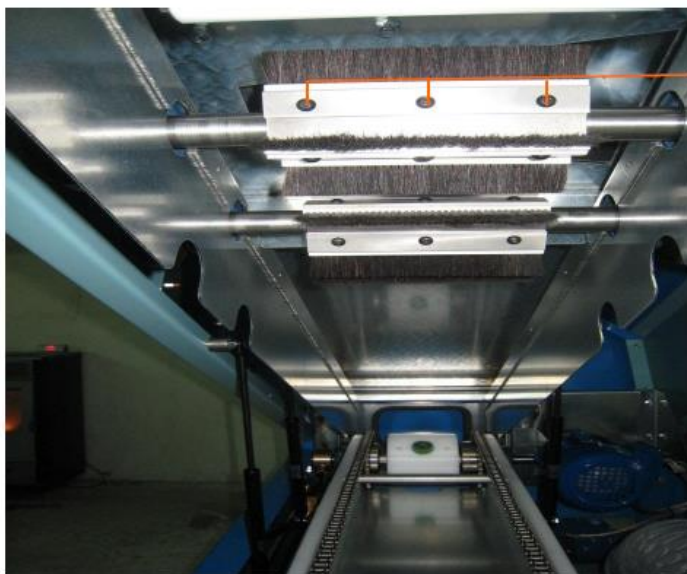
Рис. 6 Замена щёток чесальной машины
