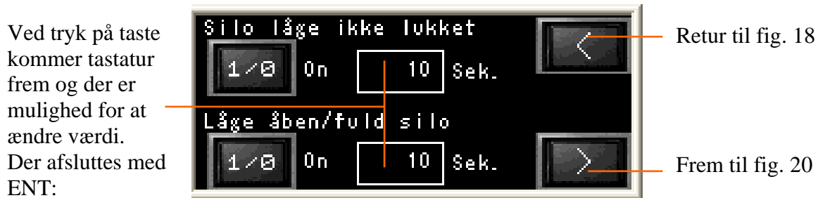
Fig. 19 Overvågning af silo.
