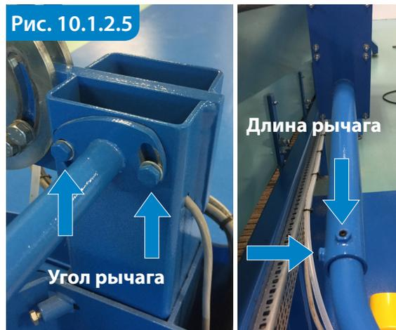
Регулировка угла рычага
