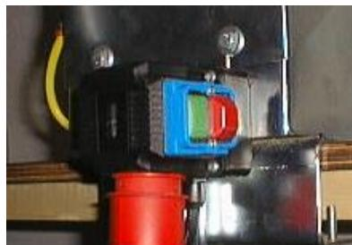
Спереди на устройстве находится переключатель. Устройство включается зелёной кнопкой, а выключается красной.
