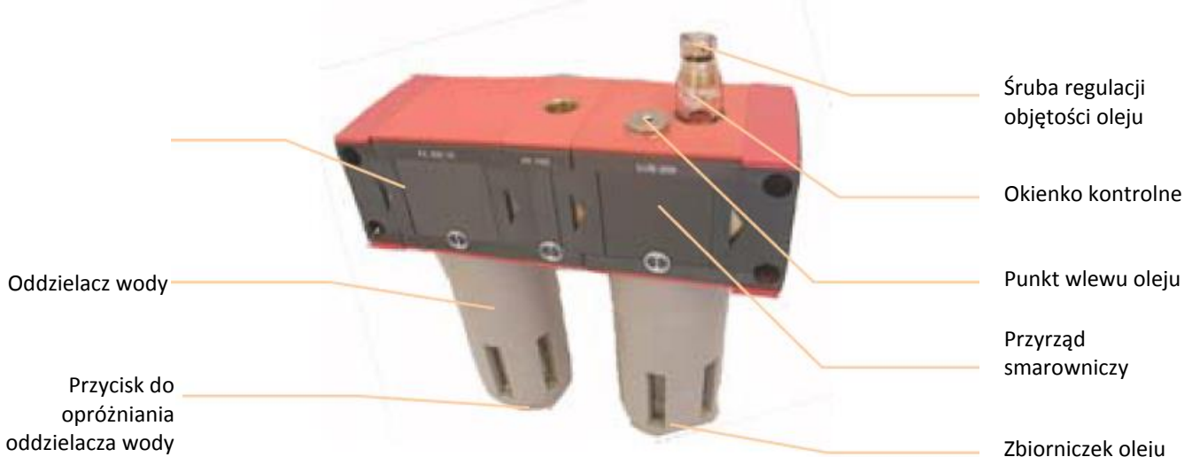
Rys. 2 Filtr powietrza i urządzenie smarownicze
