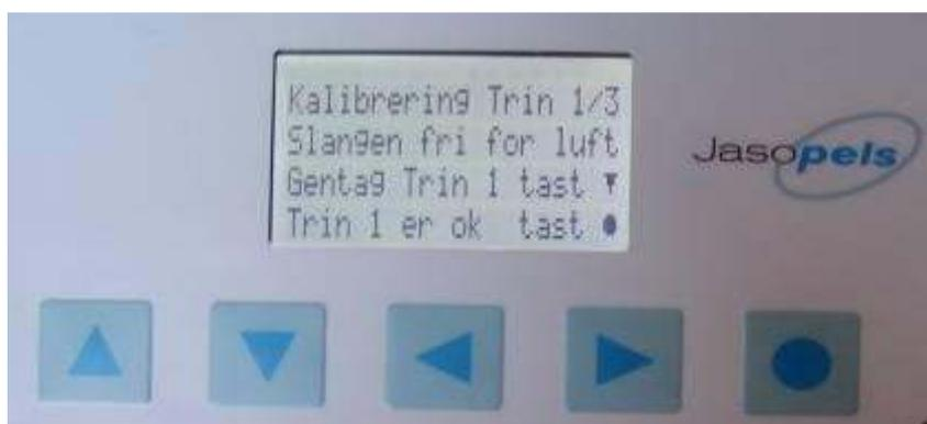
Для выполнения калибровки и контроля весов следует подготовить ведро, емкость которого вам известна. Шланг для корма поместить в ведро и нажать электрическую ножную педаль. Система дозирования накачает в ведро 20 порций по 200 г (Рис. 7).
