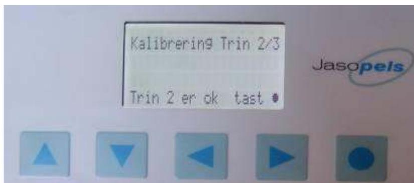
После выполнения калибровки системы дозирования следует взвесить ведро с кормом. Вес перекачанного в ведро корма ввести в компьютер системы дозирования под новым номером. Введенное значение веса сохранить, нажав кнопку «Enter». Калибровка системы завершена, и система готова к работе.
