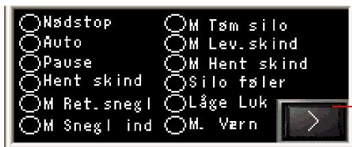
Рис. 16 Контроль вводов / выводов системы перемещения шкур
