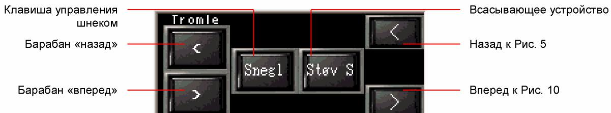
Рис. 9 Работа в ручном режиме
