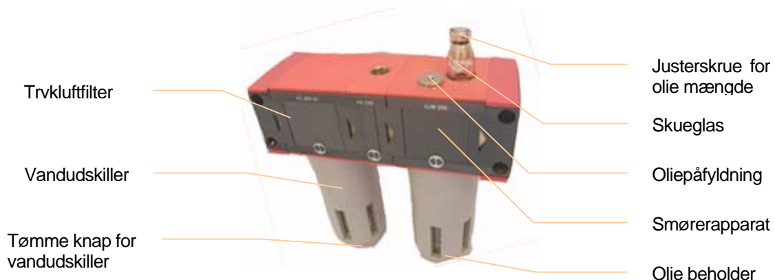
Fig. 2 Trykluffilter og smøreapparat
