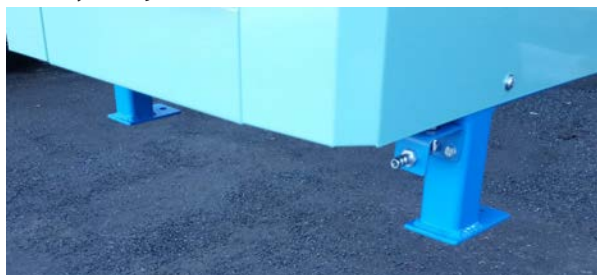
Maszynę zamocować do posadzki 3 śrubami M10x100mm.
