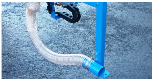
Podłączyć węże do odsysania tłuszczu.
