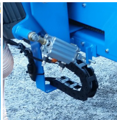
Regulacja prędkości cylindra na zaworze jednodrogowym.
