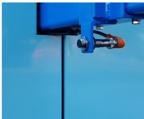
Możliwość regulacji położenia wyłącznika krańcowego.
