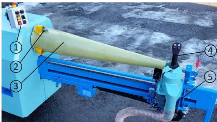
На фотографии показано панель оператора (1), зажим (2), стержень (3), джойстик (4), тележка в исходном положении (5)
