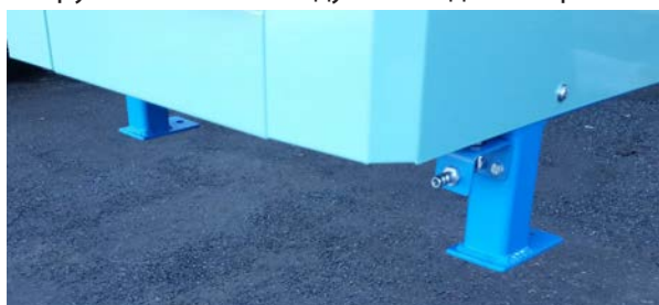
Машина крепится к полу с помощью 3 болтов M10x100мм.
