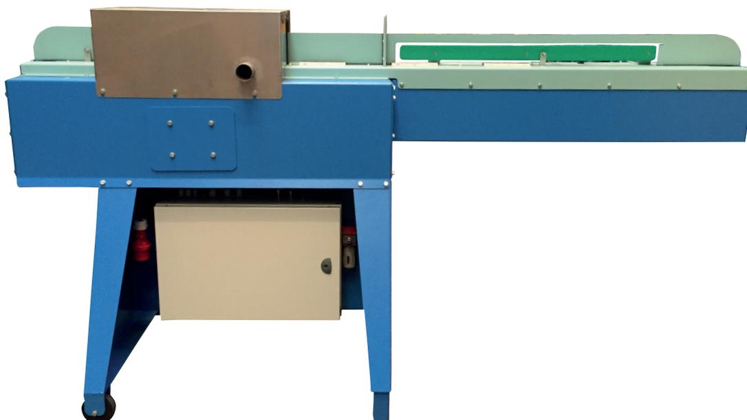
После запуска машины цепь с подавателем шкурок непрерывно движется. Шкурку уложить на одном из устройств для ослабления тыльной стороной наружу. Затем она будет протянута внутри машины слева направо, а затем выйдет наружу.
