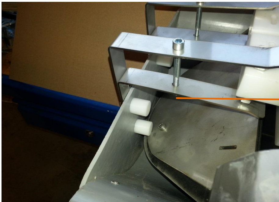
Fig. 6. Montage af plastik stop.
